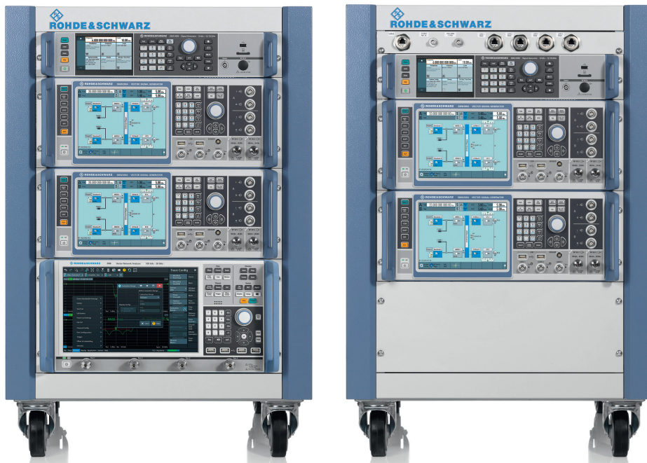
Bild 2: Vierkanaliges GNSS-Testsystem aus zwei Vektorsignalgeneratoren R&S SMW200A und einem Analogsignalgenerator R&S SMA100B für das LO-Signal (links). Das Testsystem zur Erzeugung der Störsignale (rechts) besteht ebenfalls aus zwei Vektorsignalgeneratoren R&S SMW200A und einem Analogsignalgenerator R&S SMA100B für das LO-Signal. © Rohde & Schwarz
